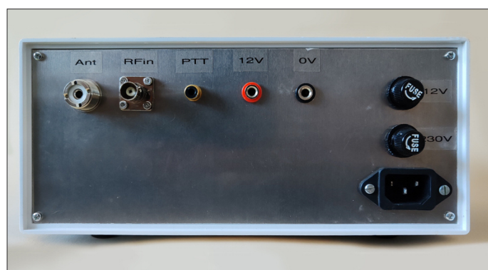
Bild E1: Rückseite der Endstufe mit den Buchsen für Antenne, Eingangssignal, PTT-Steuerleitung und optionaler externer Versorgungsspannung; rechts sind der Netzspannungsanschluss und die beiden Sicherungen zu sehen.
