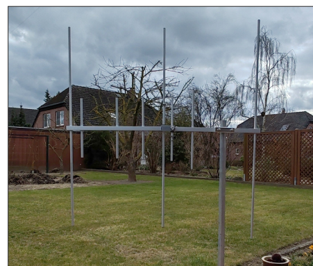
Bild E4: Senkrecht montierte Dualbandantenne im Garten
