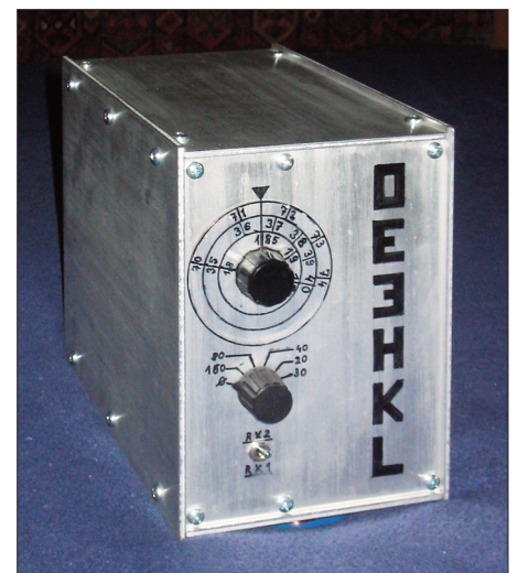
Bild 6: Der Eigenbau-Preselektor ist mit einem IP3 von mehr als +40 dBm äußerst großsignalfest.
