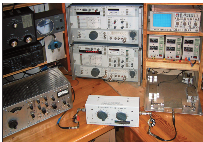
Bild 8: Zweiton-Messplatz mit gezogenen Quarzgeneratoren
