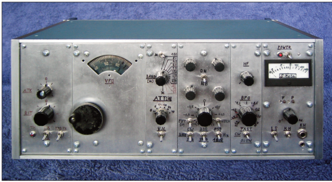
Bild 3: Der OE3HKL-RX mit H-Mode-Mixer im Gehäuse ...
