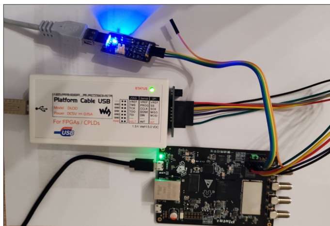
Bild E6: Verkabelung der drei Hardwarekomponenten
