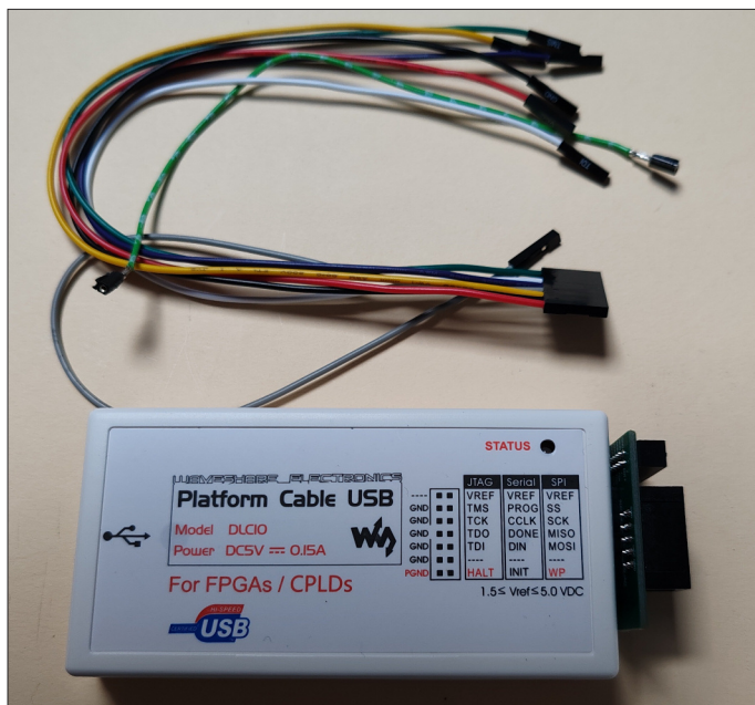
Bild E1: Modem Xilinx Platform Cable USB von für CPLD/FPGA ISP PROM FT2232 Version mit Verbindungs- kabeln
