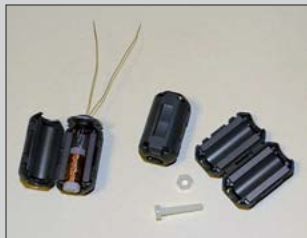
V.l.n.r.: Klappferrit mit eingelegter Spule und Abdeckung sowie geschlossener und geöffneter Klappferrit Foto: Sander
