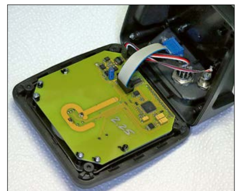
Bild 7: Innenansicht der Steuerbox, deren Anschlüsse auf der Rückseite der Gehäuseoberschale herausgeführt sind
