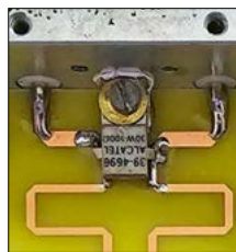
Bild 5: Verbrannter Originalwiderstand des 3-dB-Kopplers ...
