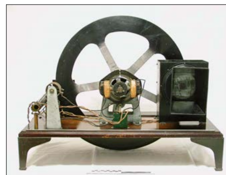
Bild 2: Bairds 1930 aufgebautes, verbessertes mechanisches Fernsehgerät
