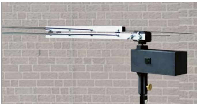
Bild 1: Test des fertig aufgebauten Rotors mit daran befestigter kleiner, logarithmisch- periodischer Antenne auf dem Balkon Fotos und Screen- shot: DM8TB
