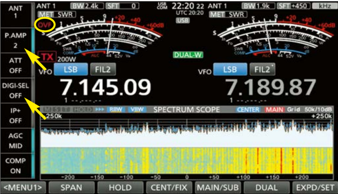
Bild 23: Trotz einer Vorverstärkung von 12 dB hielt der digitale Preselektor den Empfang im linearen Bereich.
