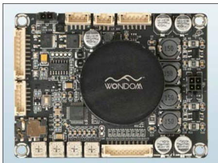
Bild 1: Wondom TPA1100 DSP JAB3 – Klasse-D-Endstufe mit 100 W Ausgangsleistung und DSP-Funktionalität Werkfoto
