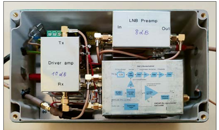
Bild 28: Blick ins geöffnete Gehäuse der externen Transceiverbaugruppe
