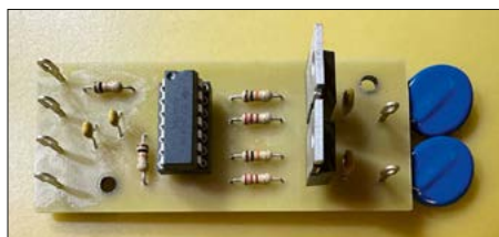
Bild 3: Die Zusatzschaltung zum Entflechten der Steuersignale ließe sich auch auf einer Streifenrasterplatte realisieren.
