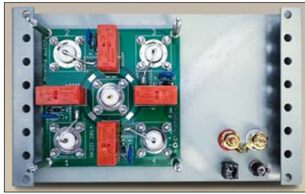
Bild 13: Befestigung des 1:4-Antennenumschalters von OK7ZI [2] an der Rückwand
