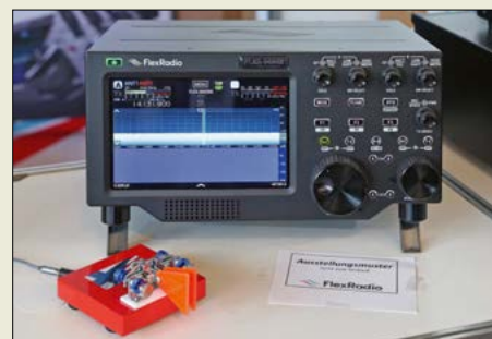
SDR-Transceiver FlexRadio FLEX-8400M mit integriertem, hochauflösendem Display und Bedienung direkt am Gerät; ein externer Computer ist somit verzichtbar.
