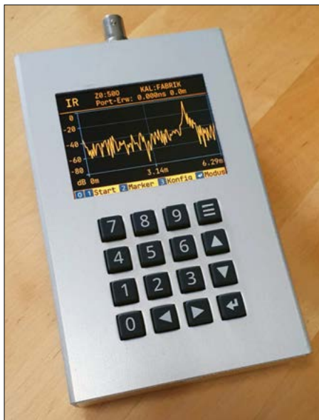
Bild 1: Prototyp des FA-VA 6, hier im noch unbedruckten Metallgehäuse; markante Merkmale sind das große TFT-Farbdisplay und das Tastenfeld. Foto: DG5MK
