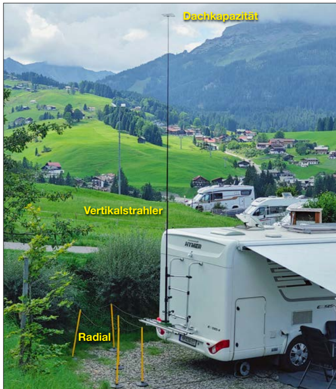
Bild 1: Am Wohnmobil montierte Mehrband-Vertikalantenne für die KW-Amateurfunkbänder; das Radial befindet sich in etwa 1 m Höhe über dem Erdboden und ist an Stangen aus Kunststoff befestigt.
