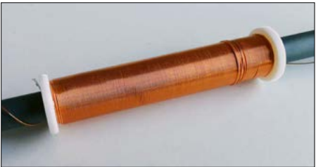
Bild 3: Ferritstab mit fertig gewickelter Antennenspule aus 953 Windungen
