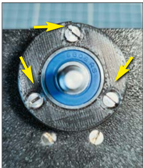
Bild 5: ... dienen zur Befestigung des Kugellagers in dem mit Senkkopfschrauben M3 x 10 mm gesicherten Lagersitz.
