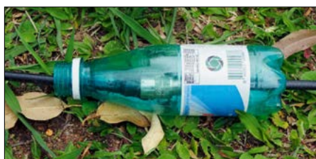
Improvisierter Regenschutz für eine Antennensteckerkupplung
