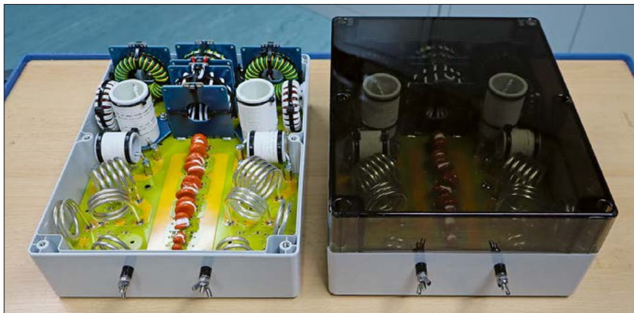
Bild 1: Ansicht zweier komplett bestückter und in Gehäuse eingebauter Antennenkoppler DigiMatch, hier die Seite mit den Anschlüssen der Zweidrahtleitung Fotos: DK1KX
