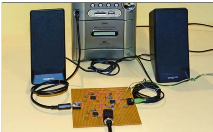
Bild 1: Bei diesem Versuchsaufbau zur Basisbreitenvergrößerung erscheint es dem Hörer, als hätten die Lautsprecher in Wirklichkeit einen größeren Abstand voneinander.
