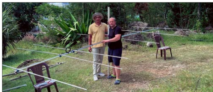
Robert, 3B9FR, und Petr, OK1BOA (r.), beim Aufbau der 6-Element-Yagi für 6 m
