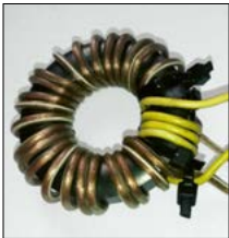
Bild 4: Mittels PVC-isolierter Litze hergestellter Übertrager Tr2
