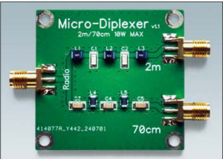
Bild 1: Diplexermodule mit 2-m-Tiefpass- und 70-cm-Hochpassfilter; die Anschlüsse sind als SMA-Buchsen ausgeführt.
