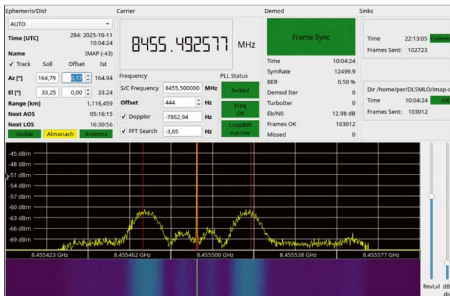
Bild 5: Ausschnitt der Bedienoberfläche der von DL5MLO entwickelten Software für Empfang, Decodierung, Tracking und Daten-Routing Fotos und Screenshot: DK7LJ
