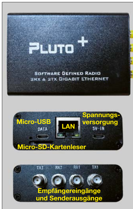
Bild 1: SDR-Transceiver Pluto Plus und dessen Anschlüsse an den Schmalseiten des Gehäuses
