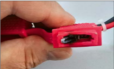
Bild 3: ... und verschmorte Sicherungshalter am Hytera-Repeater RD-985
