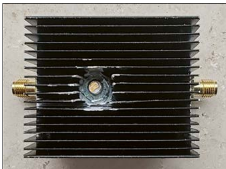
Bild 15: Für den Transistor BFQ34 der Treiberstufe kam ein modifizierter CPU-Kühlkörper zum Einsatz.
