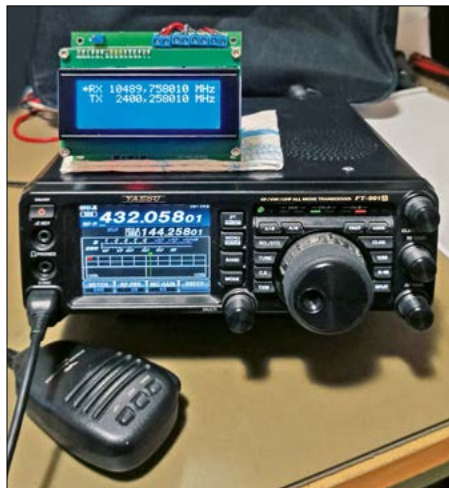
Bild 1: Die hier auf einem Yaesu FT-991A stehende Sat-Box besitzt noch kein Gehäuse. Fotos: OE2ROL
