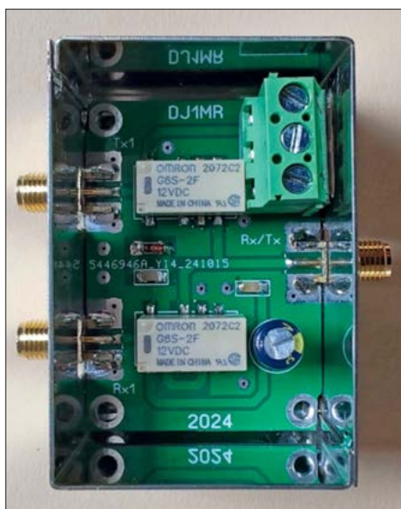
Bild 8: Mit Omron-Relais vom Typ G6S-2F bestückte RX/TX-Umschaltplatine im geöffneten Weißblechgehäuse
