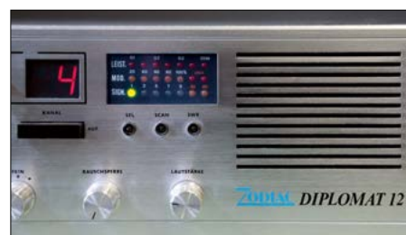
Feststation Zodiac Diplomat 12 mit 12 AM-Kanälen und 0,5 W PEP Fotos: DL1AX
