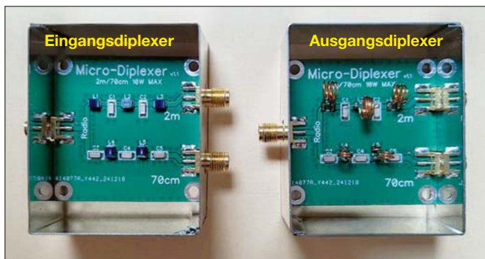
Bild 7: Eingangsdiplexer mit SMD-Spulen und Ausgangsdiplexer mit selbst angefertigten Luftspulen
