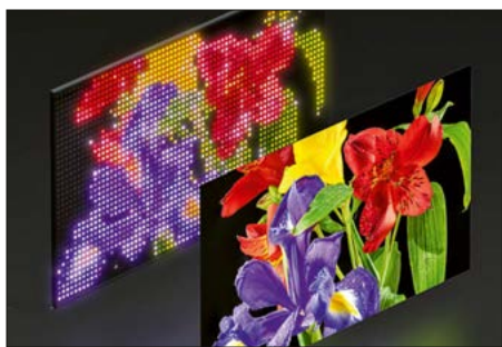
Mikro-LED-Beleuchtung: hinten Hintergrundbeleuchtung, vorn LC-Display
