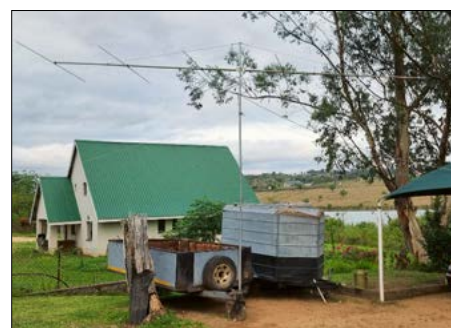
6-Element-Yagi für das 6-m-Band
