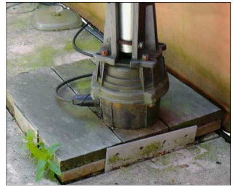
Bild 3: Der Rotor ist auf einer Hartholzplatte verschraubt, die mit Blechen zwischen den Betonplatten gesichert wurde.
