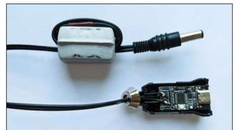
Bild 4: Industriell hergestelltes Triggerkabel mit eingebautem PD-Triggermodul COM-ZY12PDN-ST
