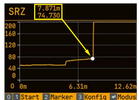
Bild 10: Sprungantwort eines 5 m langen 50- \Omega -Kabels, verlängert um 3 m 75- \Omega -TV-Kabel mit offenem Ende
