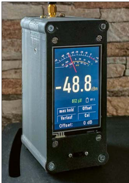
Bild 1: HF-Pegelmesser mit Nextion-Display im praktischen Einsatz; die Messwertanzeige erfolgt sowohl numerisch als auch in Form eines grafischen Zeigerinstruments. Alle Bedienelemente sind als berührungsempfindliche Tasten auf dem Bildschirm ausgeführt. Fotos: DL2IAO
