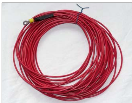
Bild 2: Eines der vier Radialbündel aus drei Drähten mit angelöteter Öse
