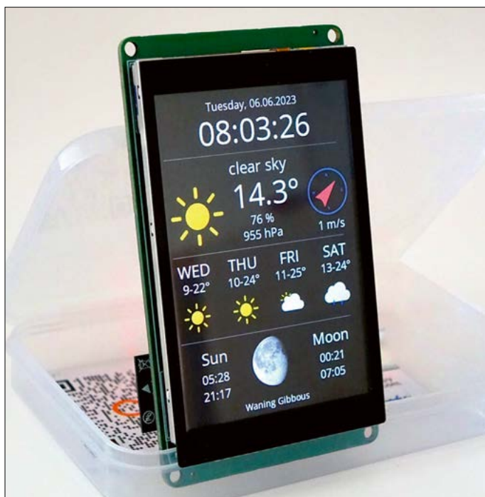
Bild 1: Fertig aufgebaute und mit der Software für eine Wetterstation programmierter Bausatz; die eingesetzte Hardware ist auch für andere Selbstbauprojekte verwendbar und würde dann nur eine entsprechend geänderte Software erfordern.
