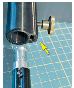
Bild 11: Stativ- halterung; in die kleine rechteckige Öffnung (Pfeil) wird bis zum Querloch für die Rändel- schraube eine M5-Mutter eingedrückt.
