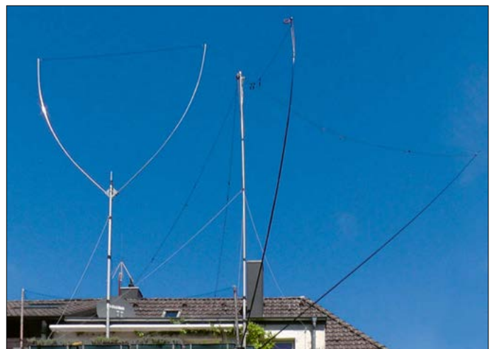
Bild 2: Gesamtansicht der Antennenanlage; die hellen Masten tragen die Antennen, die dunklen Masten dienen als Ausleger für die Dipolhälften.
