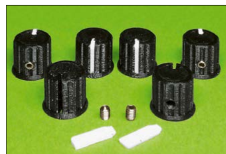
Die mit weißem Filament hergestellten Markierungsstreifen passen exakt in die Nuten der Rohlinge. Klebstoff sollte nicht verwendet werden, da er den Kunststoff angreifen kann. Foto: DJ7GP
