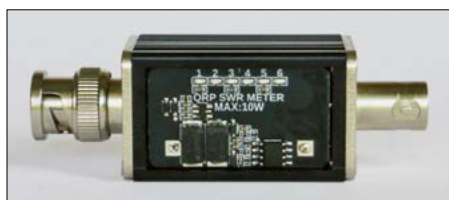
Bild 7: Nach dem Abziehen des Aufklebers wird die Auswerteschaltung sichtbar.
