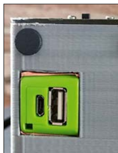
Bild 4: Anschlüsse der eingebauten Powerbank an der Rückseite des Pegelmessers
