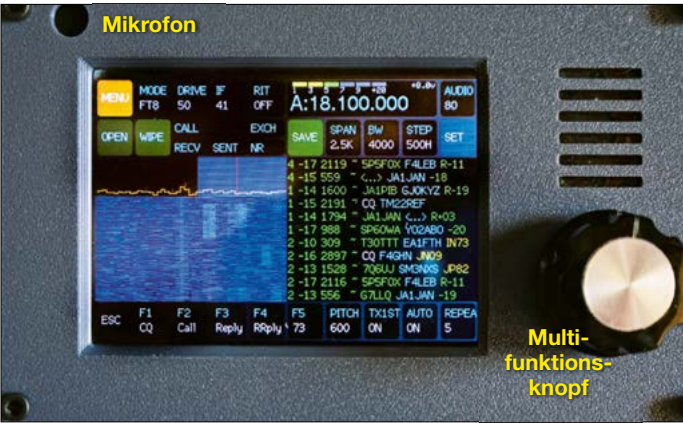
Bild 1: Ober- bzw. Front- seite des Transceivers zBitx mit Displayanzeige während des Funkbetriebs in FT8; das einzige mechanische Bedienelement ist der Multifunktions- knopf.
