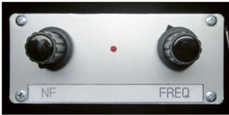
Bild 7: Frontseite des Zusatzgeräts mit den Einstellknöpfen für Lautstärke und Tonfrequenz
