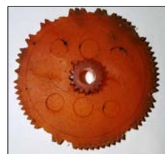
Bild 4: Zahnrad des zweiten Steuergeräts, das als Vorlage zur Digitalisierung verwendet wurde
