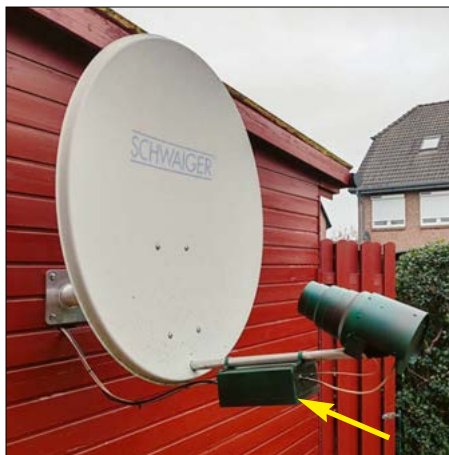
Bild 27: An einer Schuppenwand installierte QO-100-Anlage mit Antenne und externer Transceiverbaugruppe (Pfeil); der Offset-Parabolspiegel hat einen Durchmesser von 80 cm.
