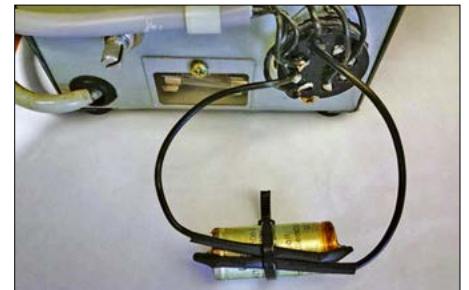
Bild 2: Von außen angeschlossener bipolarer Kondensator Foto: DK6ED
