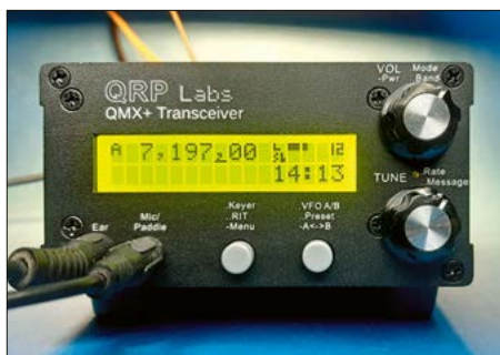
Bild 1: Alle Bedienelemente befinden sich auf der Frontplatte, ebenso wie Kopfhörer- und Mikrofon-/Paddle-Anschluss.
