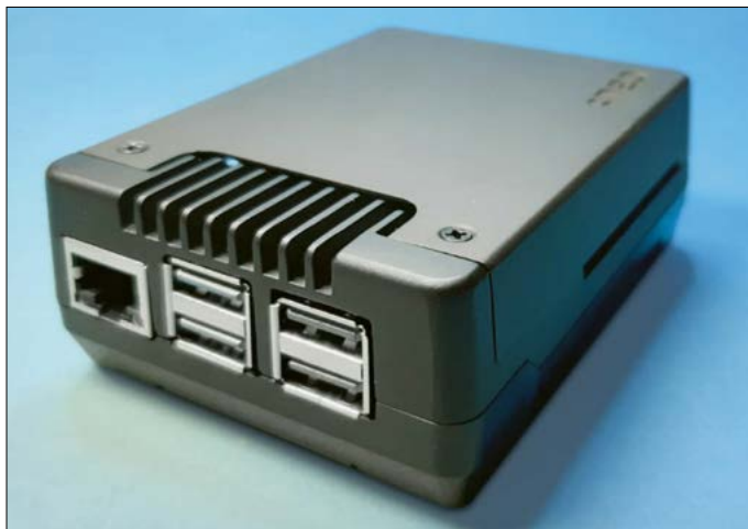
Bild 1: Gehäuse Argon NEO 5 mit montiertem Raspberry Pi 5 ; das überwiegend aus Aluminium gefertigte Gehäuseset enthält einen aktiven Wärmetauscher für das Mainboard sowie ein M.2-NVMe-Expansion-Board mit eigener Wärmeableitung zur Montage des SSD.
