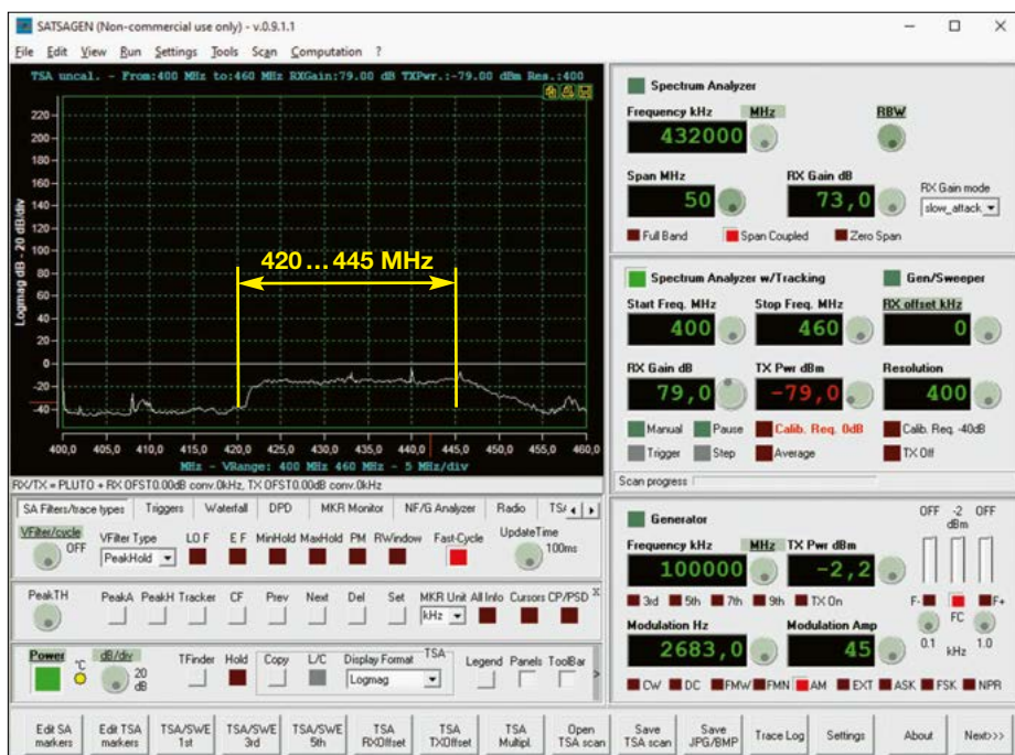
Bild 33: Das Hauptprogrammfenster der Software SATSAGEN bietet eine Vielzahl von Einstellmöglichkeiten für den Spektrumanalysator und den Tracking-Generator.
