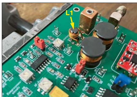
Bild 12: Die modifizierte Einkoppelspule L1 (Pfeil) verbessert den Wirkungsgrad des Modulators erheblich und verlagert die Hauptverluste nach Dr1 und Dr2.
