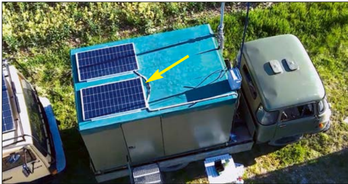
Bild 1: Der Funk-Kofferaufbau der mobilen Conteststation erhielt eine separate Photovoltaik-Anlage mit gepuffertem Akkumulator.
