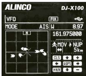
Bild 6: Beim Empfang von AIS-Signalen werden Positionen angezeigt.
