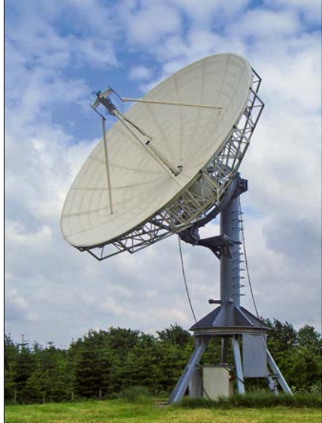
Bild 3: 7,2-m-Parabolantenne für 8,4 GHz, Aufnahme vom April 2008
