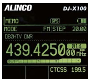
Bild 3: Displaybeispiel mit gewählter grüner Farbe beim Empfang eines FM-Signals
