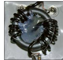
Bild 6: Verlängerungsspule für das 30-m-Band
