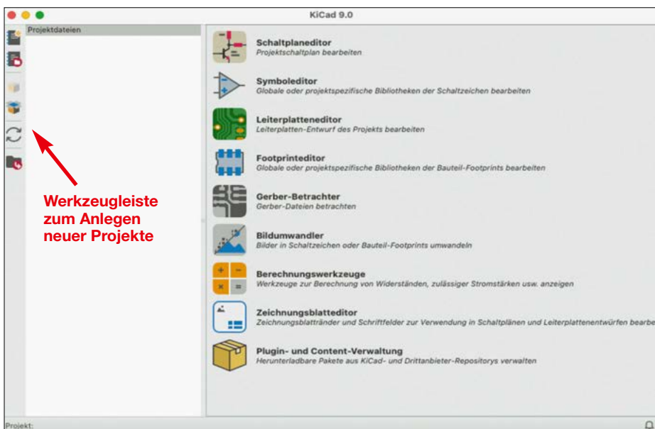
Bild 1: Programmoberfläche des KiCad-Projektmanagers mit dem Projektdatenfenster und den auswählbaren Programmkomponenten Screenshots: DM6RAC, FA
