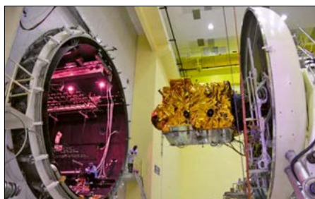
Satellit des IRNSS vor der Testkammer Foto: ISRO
