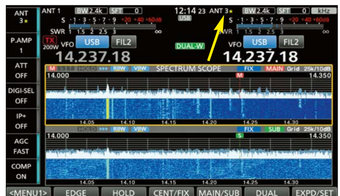
Bild 7: Ein nur zeitweilig geänderter Antenneneingang, wie hier für den Zweitempfänger, ist mit einem Sternchen gekennzeichnet.
