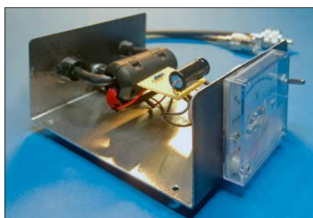
Bild 1: Mantelstromdetektor für den stationären Betrieb Foto: DC8FG
