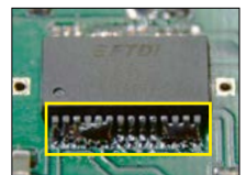
Bild 7: Beim Auflöten von ICs mit kleinem Pin-Abstand entstehende Zinnbrücken ...
