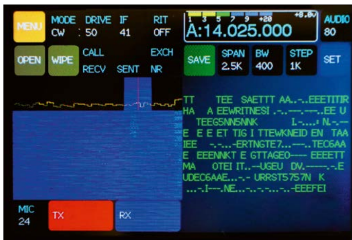
Bild 4: Bedienoberfläche und Displayanzeige des Transceivers zBitx in der Sendart CW und ohne Empfangssignal
