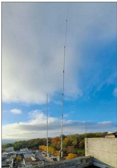
Bild 1: GPM-1500 an einem Mast auf dem Hausdach montiert, hier zum Testen noch ohne Abspannung Foto: DA6TWD
