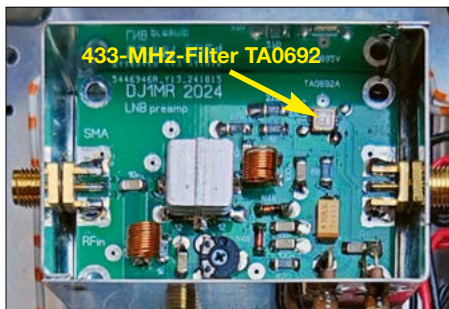
Bild 10: Bestückte Platine des Treiberverstärkers für das vom Pluto Plus bereitgestellte Sendesignal
