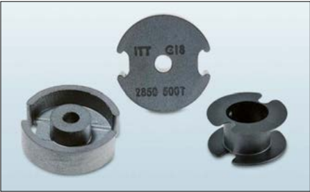
Bild 5: Die Spule des Schlossdetektors kann z. B. aus dem bei www.reichelt.de erhältlichen Schalenkern 18 × 11 mm (Material N48, A_L = 2850 \text{ nH/Wdg}^2 ) und einem passenden Spulenkörper aufgebaut werden. Werkfoto
