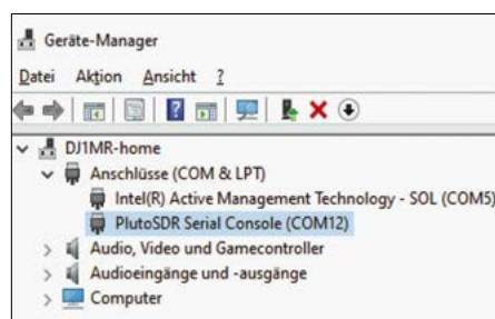
Bild 9: Reaktivierter COM-Port des Pluto Plus nach dem Booten von der SD-Karte Fotos und Screenshots: DJ1MR
