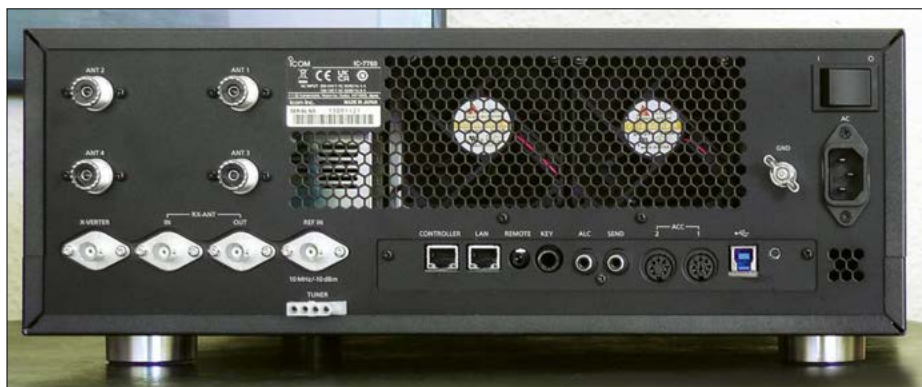
Bild 3: Rückseite der HF-Einheit; links oben vier Antennenanschlüsse, darunter Anschlü- se für Transverter, Empfangsantenne und 10-MHz-Referenzeingang, gefolgt von An- schlüssen für zweimal LAN, Remote, CW-Key, ALC, Send, ACC, USB; rechts der Netzan- schluss für 230 V und der darüberliegende Ein/Aus-Wippschalter
