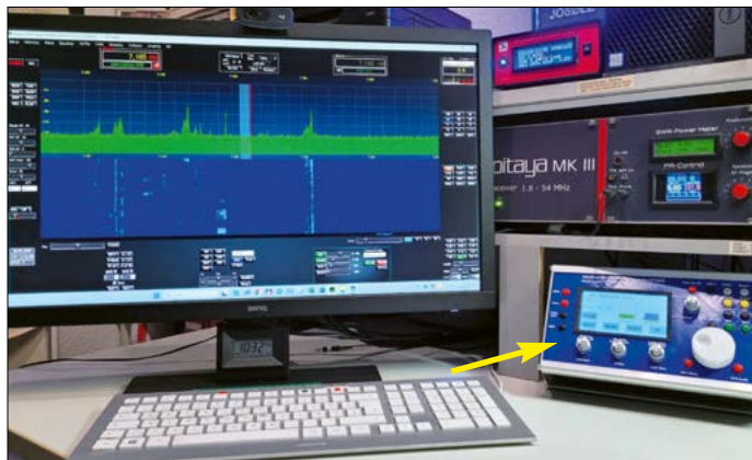
Bild 1: Odin SDR Console (Pfeil) mit der auf dem Computer laufenden Software openHPSDR im Betrieb
