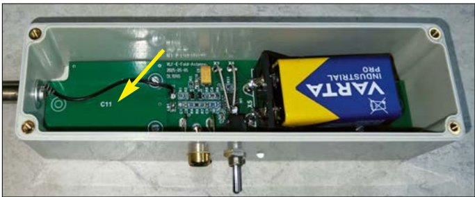
Bild 6: Komplett aufgebautes E-Feld-Antennenmodul im ABS-Gehäuse; etwa ein Drittel der Platinenfläche dient als Antenne (Pfeil).
