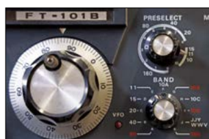
Im Yaesu FT-101B steckt auch ein Quarz für 11 m.
