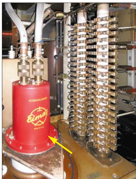
Bild 3: Die 500-kW-Senderöhre ist etwa 60 cm hoch, wiegt 70 kg und benötigt 12 kW Heizleistung.
