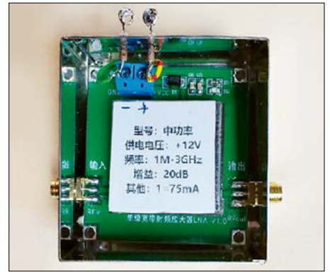
Bild 12: 20-dB-Breitbandverstärker für den Frequenzbereich von 1 MHz bis 3 GHz Fotos und Screenshots: DJ1MR
