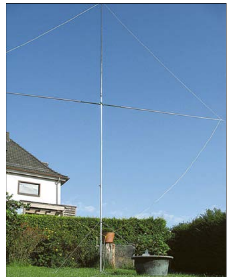
Bild 3: Quad-Antenne für das 20-m-Band Foto: DJ6SU
