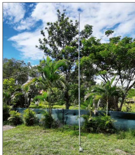
Diese 20-m-Vertikal bauten wir an beiden Standorten zuerst auf.
