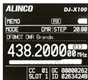
Bild 4: Empfang eines DRM-Signals mit zusätzlichen Informationen unten im Display
