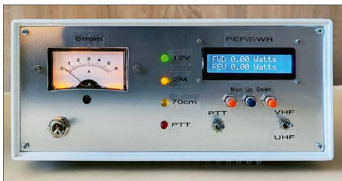
Bild 1: Frontansicht der 2-m-/70-cm-Endstufe; das Gehäuse wurde passend zu dem in [1] beschriebenen SDR-Transceiver gewählt.
