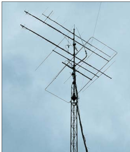
Die Antennen von G8VHI: für 2 m eine 10-Element- und für 70 cm zwei 23-Element-Yagi-Antennen Foto: G8VHI
