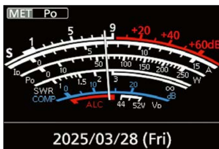
Bild 10: Die Nachbildung eines analogen S-Meters im Subdisplay
