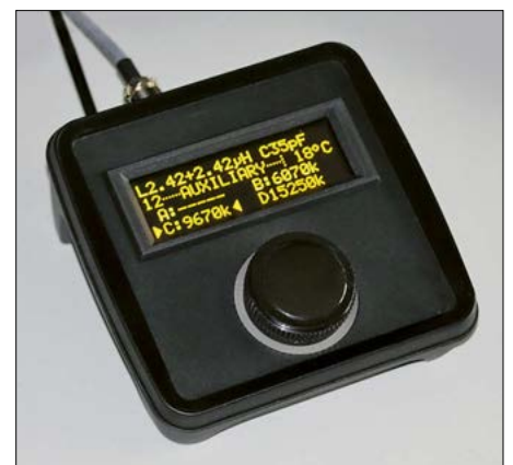
Bild 2: Die auf dem Stationstisch befindliche Steuerbox dient zur Fernbedienung der Anpasseinheit und fragt automatisch etwa einmal pro Minute die aktuellen LC-Einstellwerte ab.
