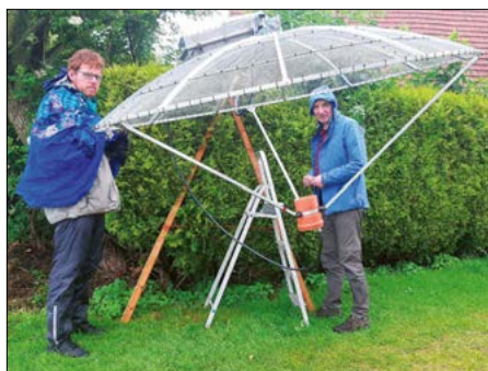
DC2CB und DM2RH fokussieren den neuen 1,9-m-Parabolspiegel.
