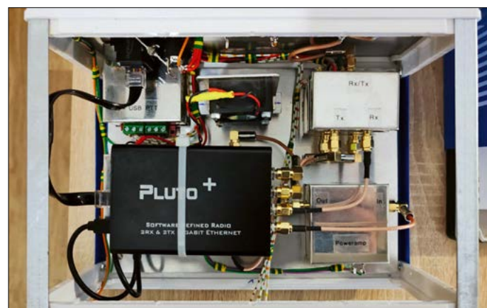
Bild 14: Blick in das geöffnete Gehäuse der internen Transceiverbaugruppe; der GPSDO wurde ausgebaut, damit die anderen Komponenten besser zu sehen sind. Unter dem Pluto Plus befinden sich der 5-V-Gleichspannungswandler sowie der selektive Sendesignalverstärker.
