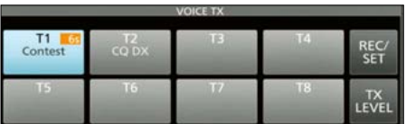
Bild 24: Acht Sprachspeicher sind verfügbar. Der hier ausgewählte Contest-Speicher zeigt eine noch 6 s dauernde Aussendung an.
