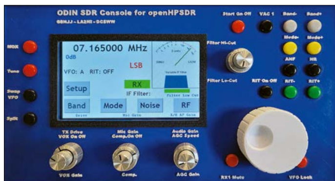
Bild 2: Frontseite der Odin SDR Console im Stil eines konventionellen Transceivers; diese wurde im 3D- Druckverfahren mit zwei farblich unter- schiedlichen Filamen- ten angefertigt.
