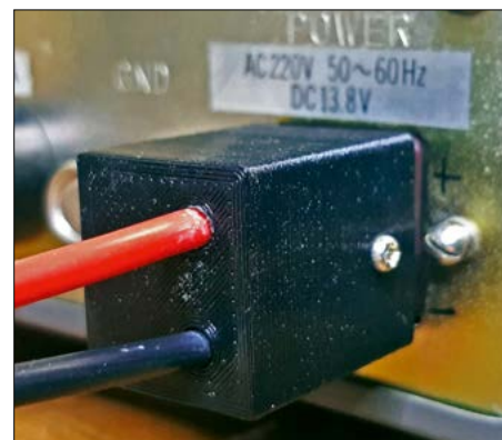
Bild 3: Der neue Stecker sitzt fest – eine Sicherung gegen versehentliches Abziehen ist nicht erforderlich.
