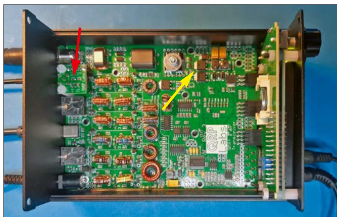
Bild 2: Auf der größeren Leiterplatte des QMX+ ist die Bestückung bequemer durchführbar als beim QMX. Die beiden Abwärtswandler für 3,3 V und 5 V (gelber Pfeil) befinden sich nun direkt auf der Platine, das optionale GPS-Modul QLG3 (roter Pfeil) wird über eine Steckerleiste angeschlossen.
