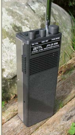
Das KW-Handfunkgerät JPX-20 SSB wiegt 500 g und ist als Bausatz erhältlich.
