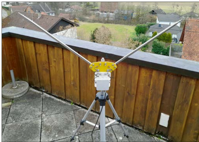
Bild 1: V-Dipol mit eingeschobenen Teleskopantennen auf einem Fotostativ Fotos: DK5IQ
