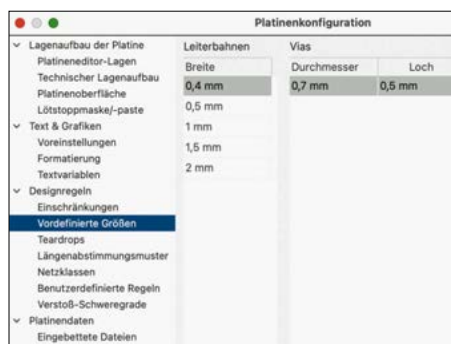
Bild 9: Definition der Leiterbahnbreiten
