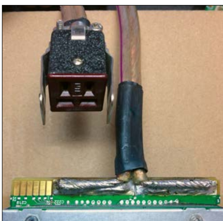
Bild 7: Beispiel für den Anschluss eines Kabels an den Ausgang des Netzteils, hier an den Kontaktflächen auf der Unterseite der Platine
