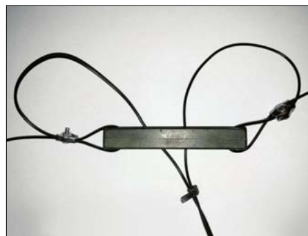
Bild 7: Speisepunkt eines mit Zwillingslitze gespeisten Dipols
