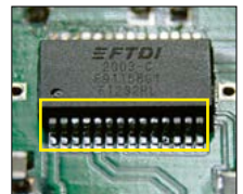
Bild 8: ... lassen sich mithilfe von Entlötlitze leicht entfernen, sodass am Ende saubere Lötstellen entstehen.
