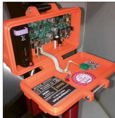
Geöffnetes Lichtsprechgerät mit dem Bausatz Elise 2.0
