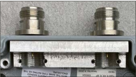
Bild 4: Der Masseanschluss der beiden N-Buchsen erfolgt mithilfe eines gefrästen Aluminiumblocks.
