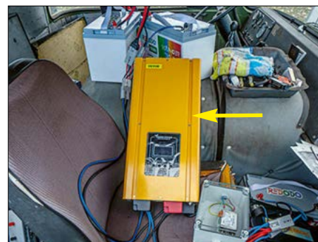
Bild 6: Wechselrichter zur 230-V-Spannungsversorgung von Endstufe und Computertechnik
