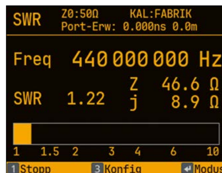
Bild 6: Ergebnis der SWV-Messung einer 70-cm-Antenne im Modus Einzelfrequenzmessung
