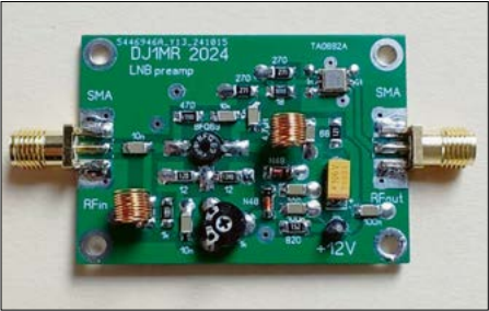
Bild 23: Bestückte Platine des 432-MHz-Vorverstärkers
