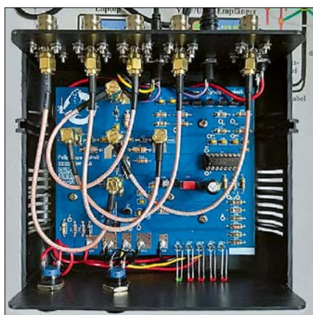
Innenansicht des Antennenumschalters von DO9WA für den Dopplerpeiler
