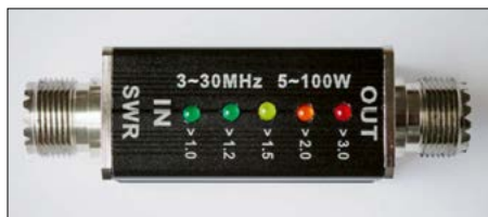
Bild 1: Gehäusevorderseite des SWV-Indikators auf Basis eines Richtkopplers, ...
