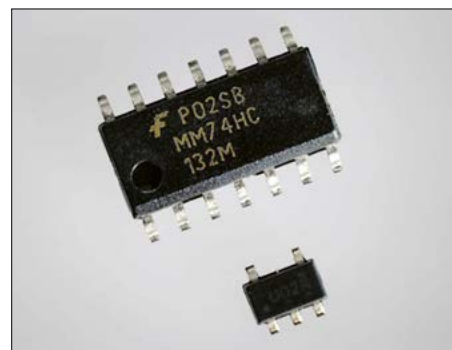
Größenvergleich zwischen einem SMD-Schaltkreis der HC-Familie mit vier NAND-Gattern im SO-14-Gehäuse und einem IC der LVC-Familie mit einem einzelnen NOR-Logikgatter im Gehäuse SOT-23-5
