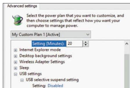
Bild 6: Einstellungen zum Energiemanagement der USB-Schnittstelle
