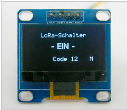
Bild 4: Anzeige des Schaltzustands, des mit den Lötbrücken gesetzten Hardware-Codes und der gesetzten Brücke M
