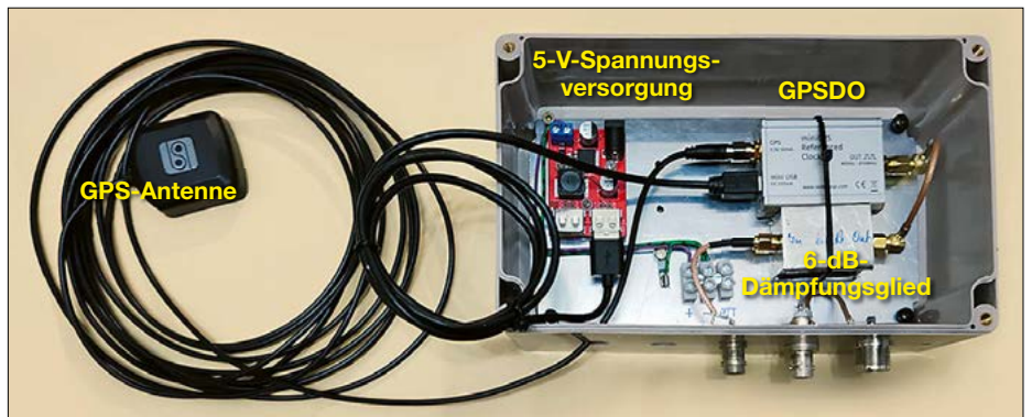
Bild 21: Aufbau des GPSDO im Gehäuse, das zum Schutz vor Witterungseinflüssen dient
