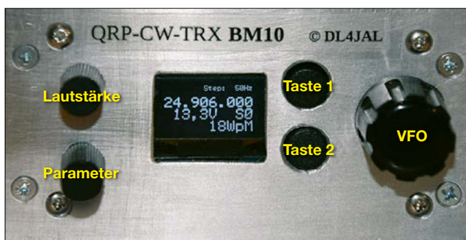
Bild 18: Frontplatte des Transceivers mit den Bedienelementen und dem OLED-Display Fotos und Screenshots: DL4JAL
