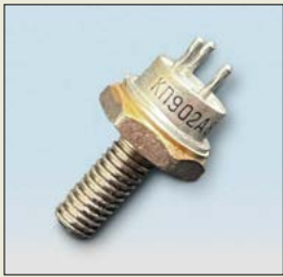
N-Kanal-FET KP902A; der KP903B besitzt ein baugleiches Gehäuse.
