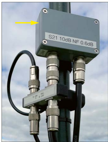
Bild 1: Der beschriebene Vorverstärker war am Mast der Yagi-Antennengruppe von DR2L im Mai-Contest 2025 erfolgreich im Einsatz.
