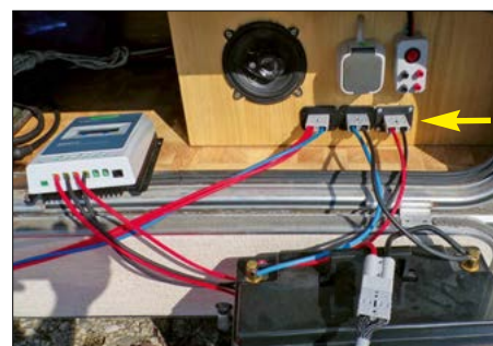
Bild 7: Das eingesetzte 50-A-Steckersystem bietet eine hohe Flexibilität beim Zusammenschalten der Energiequellen.
