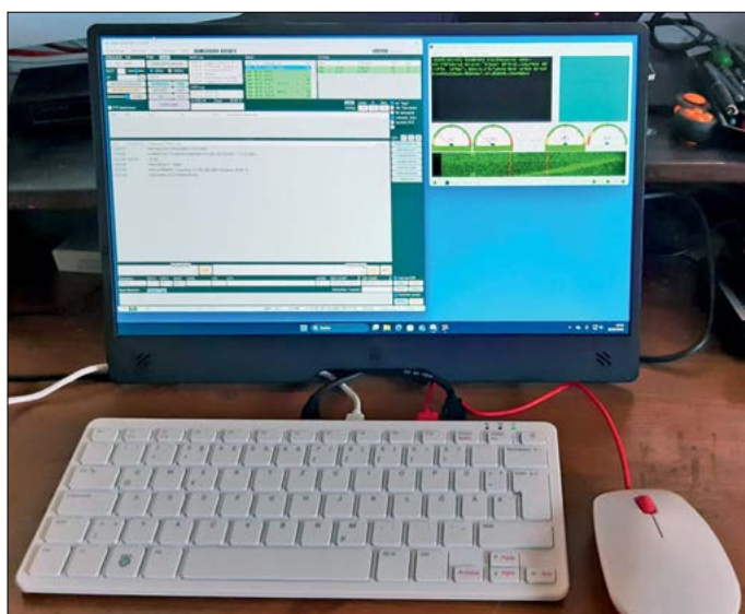
Bild 5: Windows 11 lässt sich mithilfe von Botspot Virtual Machine problemlos auf einem Raspberry Pi 5 bzw. 500 installieren. Mindestvoraussetzung sind 8 GB RAM. Je höher die Datenrate der Micro-SD-Karte für sequenzielles Lesen ist, desto höher ist die Performance dieser Arbeitsumgebung. Ein Wert von 200 MB/s ist bereits ausreichend.
