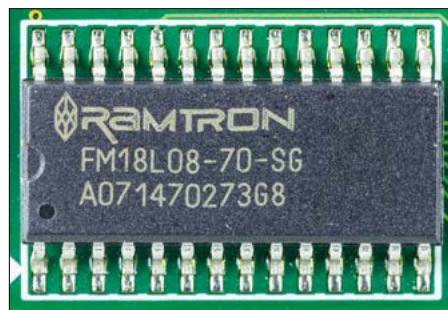
Bild 1: FRAM-Speicher von Ramtron aus einem tragbaren Medizingerät
