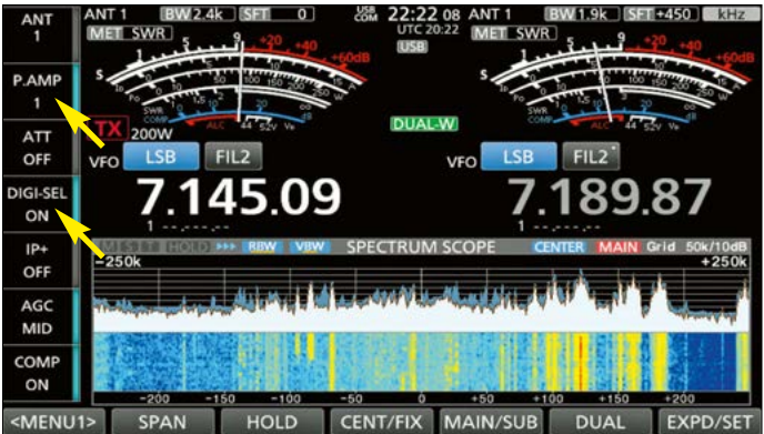
Bild 23: Trotz einer Vorverstärkung von 12 dB hielt der digitale Preselektor den Empfang im linearen Bereich.
