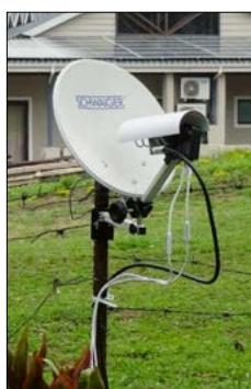
Die 60-cm-Parabolantenne für QO-100 montierten wir an einem Zaunpfahl.
