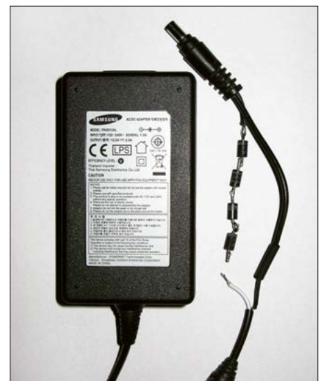
Bild 5: 12-V-Schaltnetzteil Samsung PN3012 AL zur Spannungsversorgung; vier in Serie geschaltete Dioden 1N5400 in der Zuleitung reduzieren die Ausgangsspannung auf ungefähr 9 V, die Betriebsspannung des µBitX.
