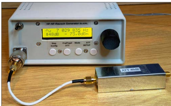
Bild 1: Fertig aufgebauter HF/NF-Funktionsgenerator mit angeschlossenem externem 48-dB-Dämpfungsglied; mit dieser Kombination lassen sich sehr geringe, präzise einstellbare Signalpegel z. B. für Empfindlichkeitsmessungen erzeugen.
