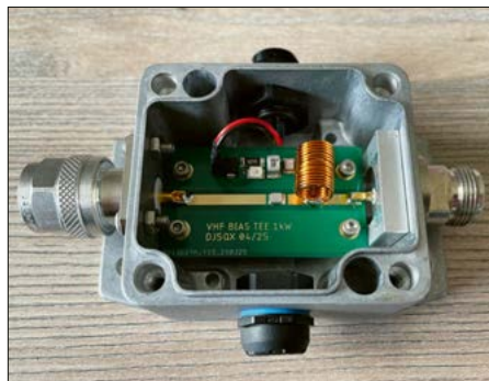
Bild 9: Bestückte Bias-T-Platine im Aluminium-Druckgussgehäuse
