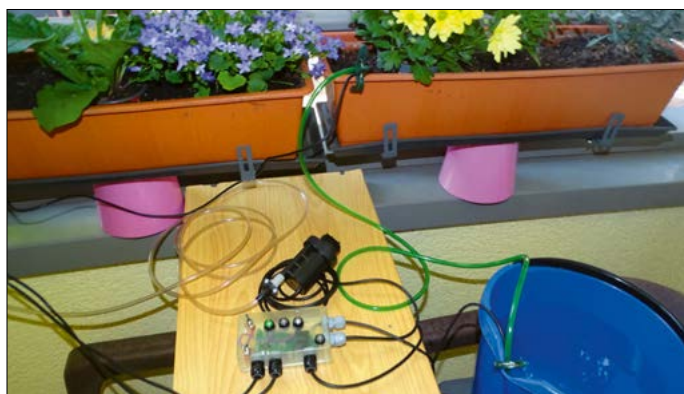
Bild 1: Den Blumengießautomaten habe ich mit Erfolg bei den Pflanzen in meinen Balkonkästen getestet. Die zweite Wasserpumpe befindet sich noch nicht im Wasserbehälter.
