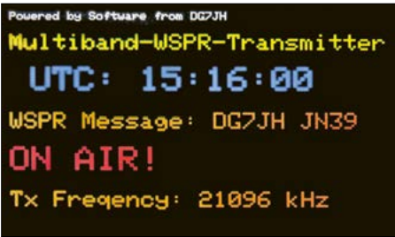
Bild 8: Bildschirmanzeige während der Aussendung einer WSPR-Message; die aktuelle Sendefrequenz wird in der untersten Zeile angezeigt.
