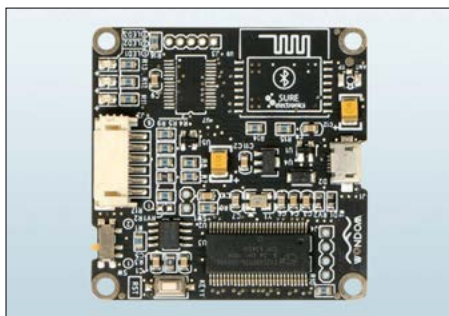
Bild 2: Programmiermodul Wondom ICP1 von Sure Electronics Werkfoto
