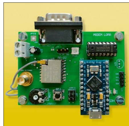
Bild 2: Experimentelles LoRa-Modul auf Basis des Entwicklungsboards Pro Micro
