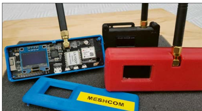
Bild 2: Verschiedene LoRa-Module für das MeshCom-Netzwerk, hier in 3D-Druck-Verfahren hergestellten Gehäusen Fotos und Screenshots: OE3MZC
