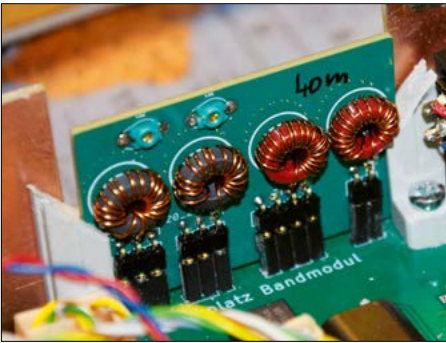
Bild 5: Steckmodul für das 40-m-Band mit den Ringkernspulen der Tief- und Bandpassfilter; die SMD-Kondensatoren befinden sich auf der Rückseite der Platine. die Impedanz von 50 Ω auf etwa 1,5 kΩ und dient zur symmetrischen Ansteuerung des ersten Mischereingangs an dessen Pins 1 und 2. Die Mischverstärkung beträgt etwa 17 dB. Das Empfangssignal wird auf eine ZF von 9,215 MHz gemischt. Am Mischerausgang Pin 5 sorgt die Kombination aus C111 und L101 für die Impedanzanpassung an das Quarz-Abzweigfilter.
