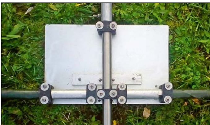
Bild 7: Fußpunkt mit auf der Grundplatte isoliert befestigten Tragrohren
