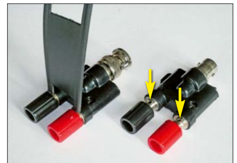
Bild 3: Leitungen lassen sich beim GE 860 (li.) und K 126 mithilfe von 4-mm-Steckern anschließen oder direkt in den Querlöchern festklemmen. Fotos: DK3RED
