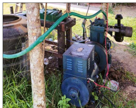
Der alte Generator sorgte durch Spannungsschwankungen für Probleme. Nach einigen Tagen wechselten wir auf ein größeres und moderneres Aggregat.
