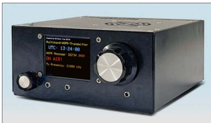
Bild 1: QRP-Transceiver \mu BitX V6, modifiziert für den Betrieb als WSPR-Bake
