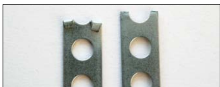
Bild 6: Die Enden der Montagebänder sind so zu präparieren, wie links zu sehen.
