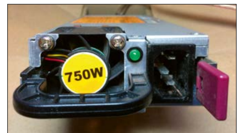
Bild 4: Frontseite des Netzteils mit Lüfter, Einschaltkontroll-LED und Kaltgerätesteckverbinder
