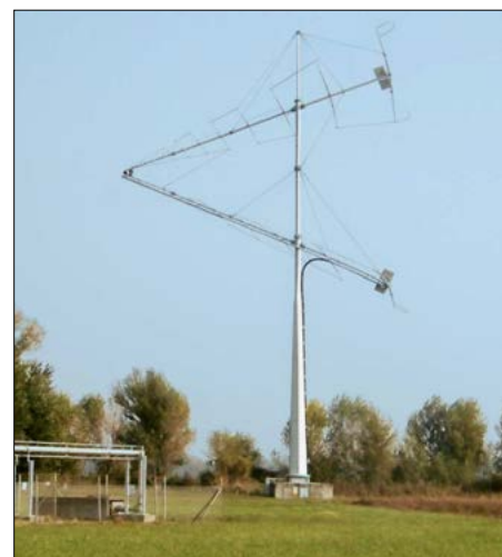
Bild 4: Drehbare logarithmisch-periodische Antenne des Senders Moosbrunn
