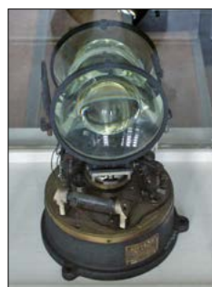
... und in einer weiteren eine der zur Kennzeichnung des Turms als Luftverkehrshindernis genutzten Lampen.
