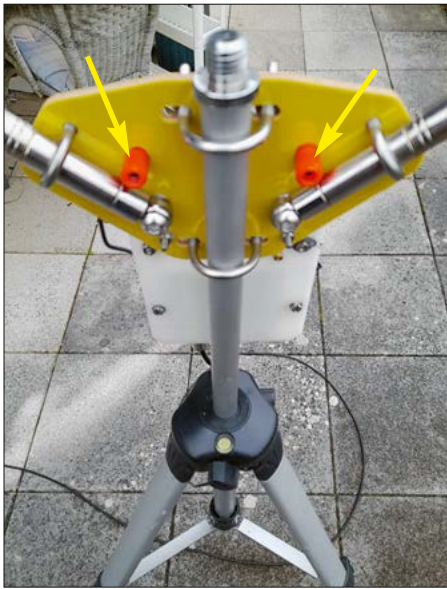
Bild 3: An die Buchsen (Pfeile) wird bei Bedarf die Stichleitung angeschlossen.
