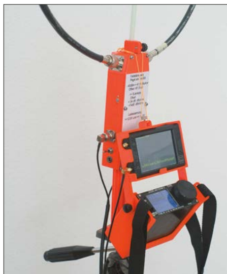
Eigenbau-Loop mit Feldstärkemessgerät und Empfänger ATS25 Foto: HB9TNW
