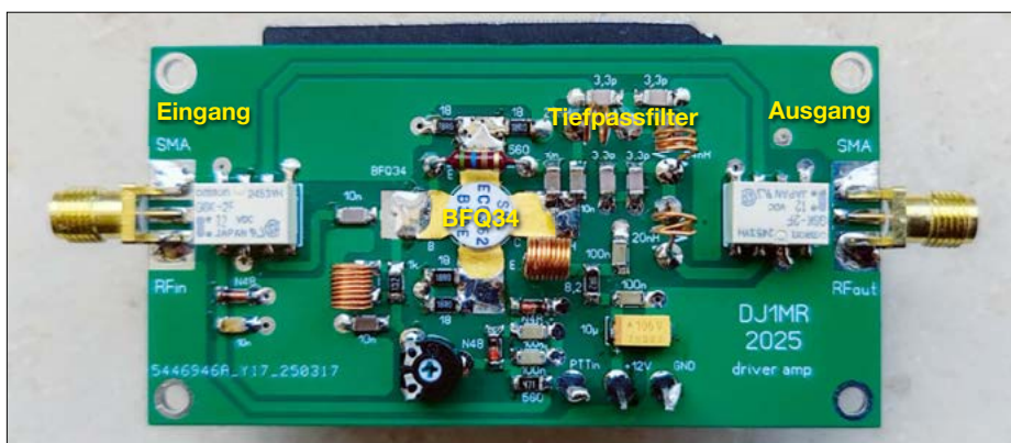
Bild 14: Vollständig bestückte Platine der Treiberstufe
