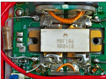
Bild 4: Der MRF186 ist ein Doppel-MOSFET, der bis in den UHF-Bereich einsetzbar ist.
