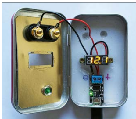
Bild 3: Innenansicht mit Trigger- und Mini-Digitalvoltmeter-Modul Fotos: DM4TG
