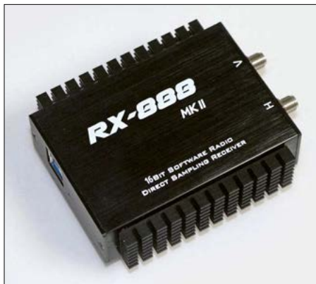
Bild 1: Der RX-888 MKII ist in einem schlichten schwarzen Metallgehäuse untergebracht, dessen Kühlrippen für ausreichende Wärmeabfuhr sorgen sollen. Werkfoto
