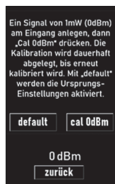
Bild 2: Die Kalibrierung des Pegelmessers ist menügeführt und dadurch recht einfach zu bewerkstelligen.
