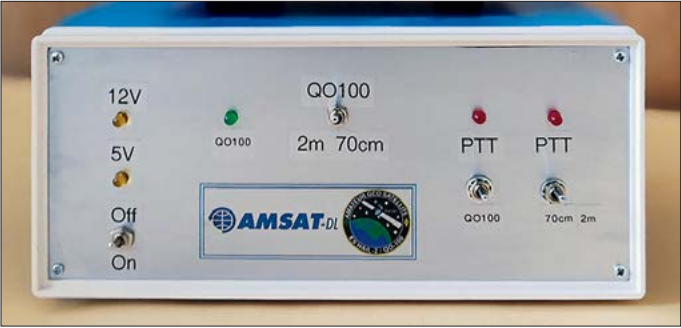
Bild 1: Frontansicht des im Shack befindlichen Teils des Eigenbau-Transceivers für den Funkbetrieb über QO-100 und auf 2 m oder 70 cm
