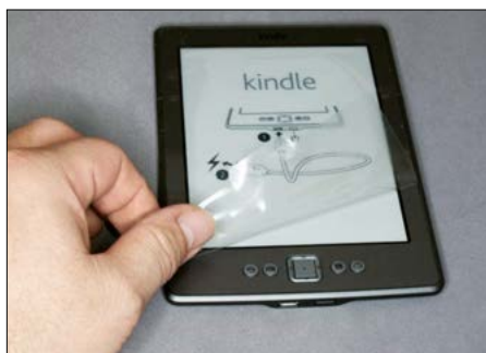
Abziehen der Schutzfolie von einem frisch ausgepackten Gerät. Die Anschlusskizze wird per E-Ink auf dem Display dargestellt.
