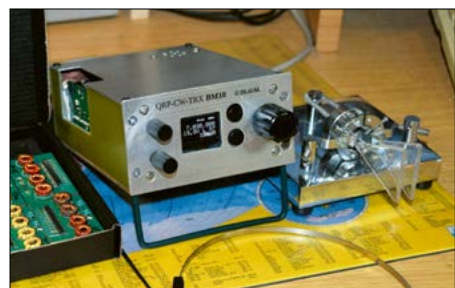
QRP-Transceiver BM10 auf dem Stationstisch; die Bandumschaltung erfolgt durch ein seitlich eingestecktes Modul. Foto: DL4JAL
