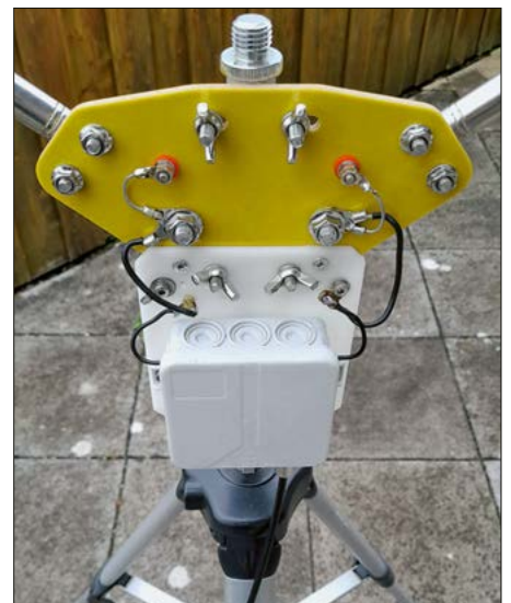
Bild 2: Anschlussseite der Grundplatte des V-Dipols; der 2:1-Breitbandübertrager ist in einer Abzweigdose aus der Elektroinstallations-technik untergebracht. Die Befestigung der Teleskopstäbe an der Grundplatte sowie die Montage am Fotostativ erfolgt mithilfe von Bügelschellen, siehe auch Bild 3.
