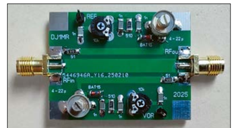
Bild 17: Aufbau des Richtkopplers in Streifenleitertechnik
