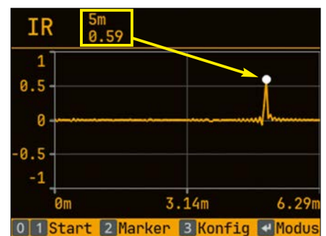
Bild 9: Impulsantwort eines 5 m langen 50- \Omega -Kabels mit offenem Ende
