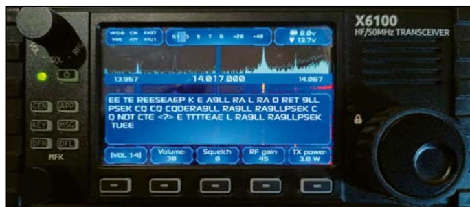
Bild 1: Die alternative Firmware erweitert den Xiegu X6100 z. B. um eine Decoderfunktion für CW-Signale.
