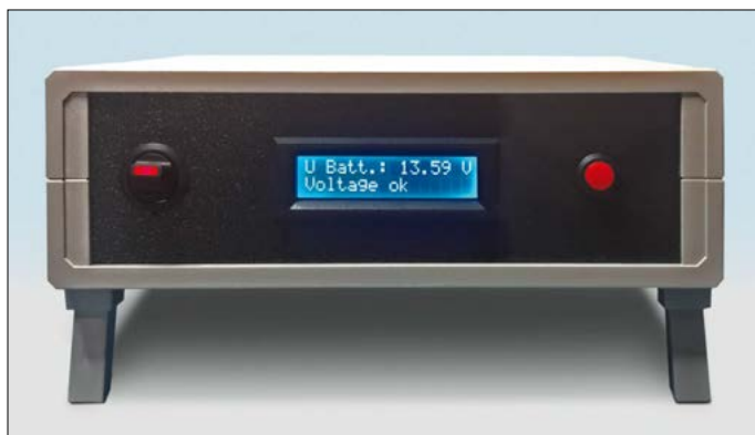
Bild 1: Überwachungsgerät für eine netzunab- hängige Stromver- sorgung im Gehäuse Bopla Ultramas UM52011L
